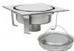
P.012 CHIUSINO 300x300 RINFORZATO, SCARICO Ø 101,6/110 mm
